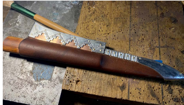
Установка U-образных скоб и обрезка излишков кожи
