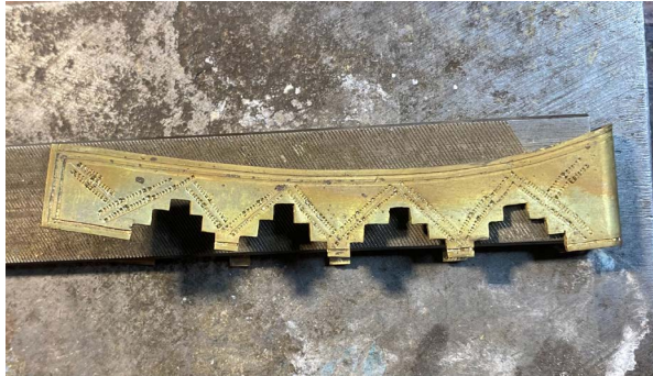
Пластина и ее деформация в процессе чеканки
