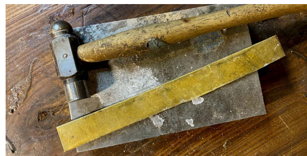
После обрезки край загибается, поэтому необходимо выровнять
